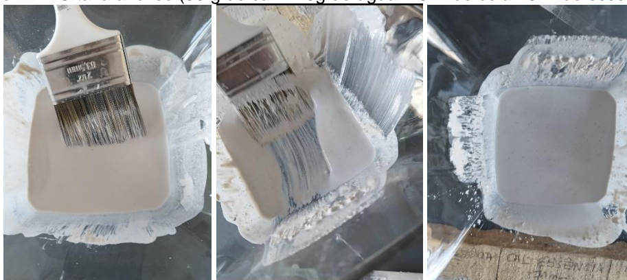
Foto 11 – Oitava análise (50 g de cal + 70g de água + 5ml de cola+ 5ml de essência)
