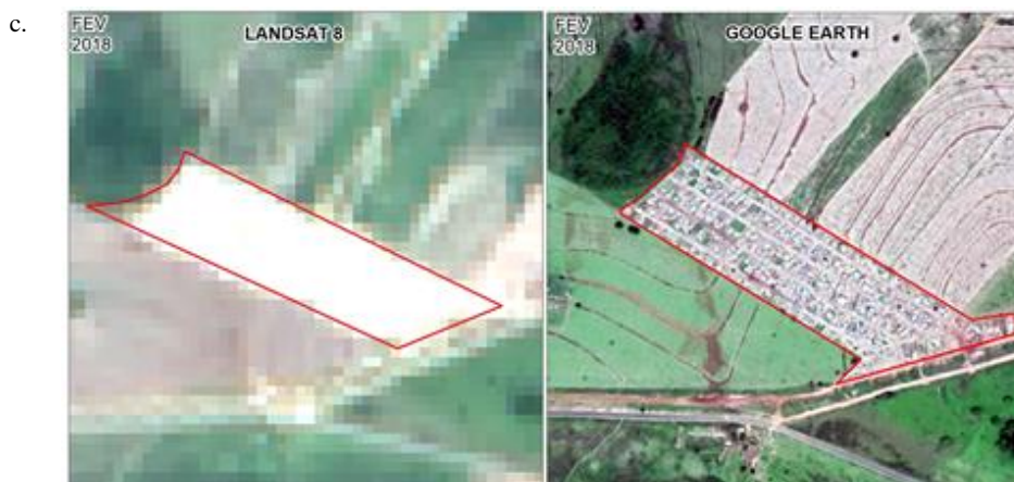
Figura 6. Validação da interpretação por comparação das imagens Landsat (4-3-2) e Google Earth de junho de 2016 (6a. área ainda não explorada), 2017 (6b. cerca de um terço da área ocupada moradias) e 2018 (6c. reflectância muito alta indica espaço tomado por construções com superfície muito reflexivas).
