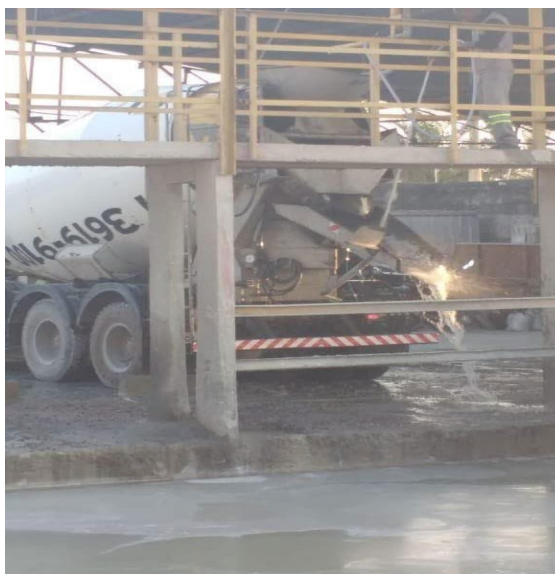
Figura 2: Lavagem dos caminhões betoneira
