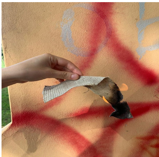
Figura 13 - Teste de identificação à queima com tecido da urtiga dióica
