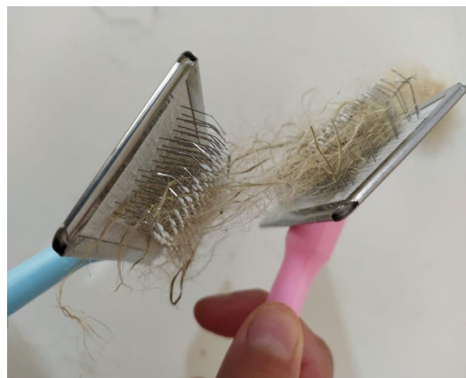
Figura 9 - Processo manual de cardagem, por meio do atrito da raspagem da fibra entre as duas escovas
