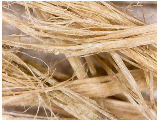
Figura 16 - Teste de morfologia das fibras do urtigão com método de análise: 500 x aproximações
