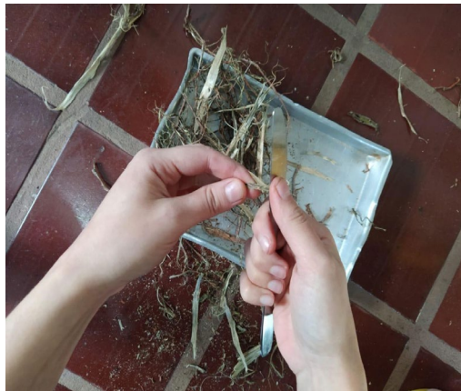
Figura 7 - Limpeza manual das fibras por meio utilização de uma faca sem serra
