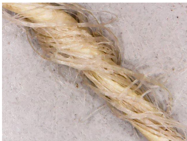
Figura 15 - Teste de morfologia de fio do urtigão com método de análise: 500 x aproximações
