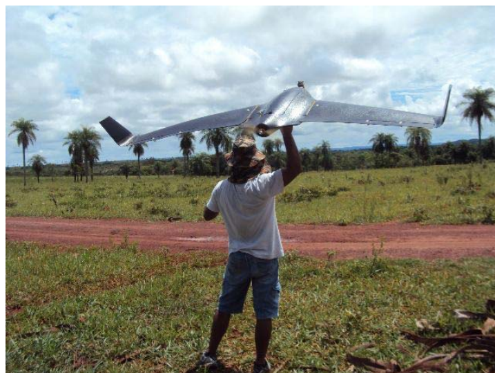
Figura 23.4. Decolagem de RPA por lançamento Manual. RPA construída por graduando em Engenharia Ambiental da UFMS, o qual é coautor deste capítulo. A carcaça é de isopor, envergadura de 218 cm, com payload de 1,2 kg, com velocidade de cruzeiro de até 55 km/h.
