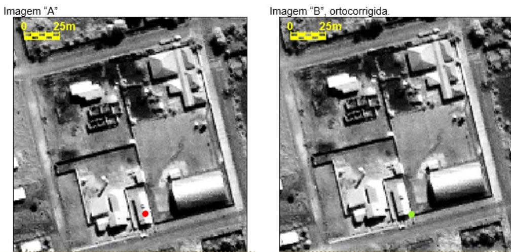
Figura 5.12. O ponto em vermelho teve sua coordenada obtida com GPS de precisão, mesmo assim sua posição sobre a imagem apresenta deslocamento. Na imagem "B", que se encontra ortocorrigida, o ponto obtido em campo está na posição exata que ocupa no mundo real (modificado de OLIVEIRA, 2005).
