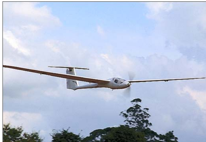
Figura 23.3. Tiriba um modelo de VANT fabricado no Brasil utilizado em aplicações ambientais. Este modelo possui 4 kg, com payload de 0,7 kg, autonomia de 1 h e velocidade de cruzeiro de até 100 km/h (adaptado de BRANCO et al., 2011).
