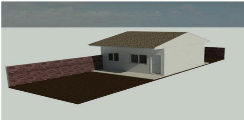
Figura 10 – 14º dia de execução no sistema em light wood frame .
