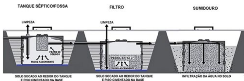
Figura 2 – Estilização de um sistema composto por Fossa Séptica, Filtro e Sumidouro
