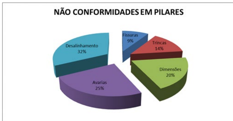
Gráfico 2 - Não conformidades identificadas em pilares antes e após a montagem
