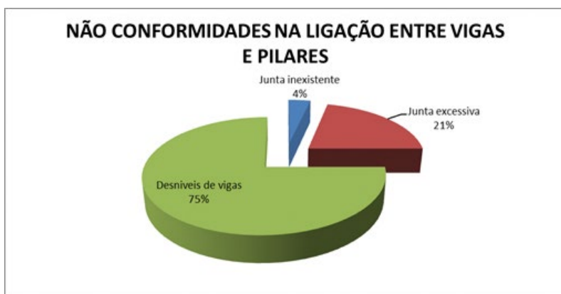
Gráfico 3 - Não conformidades na ligação entre vigas e pilares após a montagem
